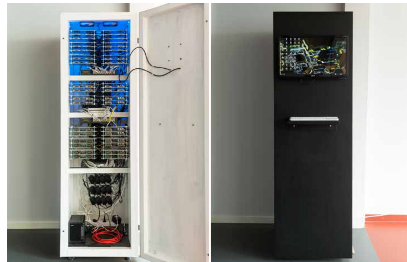
Mynd 4. Skápið uttan um Raspberry Pi klasan. Á myndini vinstrumegin stendur skáphurðin opin, so at klasin sæst. Høgrumegin er hurðin aftur og nú síggjast skíggin og lykklaborðið, sum eru bundin í meginknútin.
